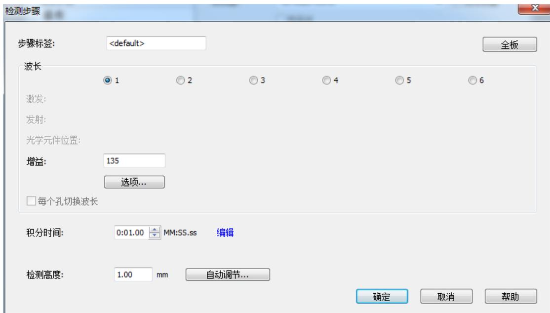
使用发光光纤进行发光检测时，无需选择激发和发射波长。
