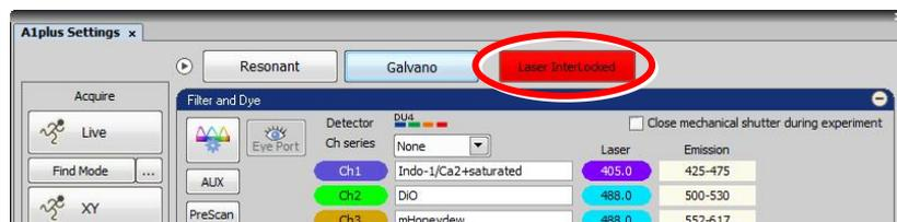
19.5 设定 Optical Path。（设定获取图像所需的共聚焦系统的光路）
